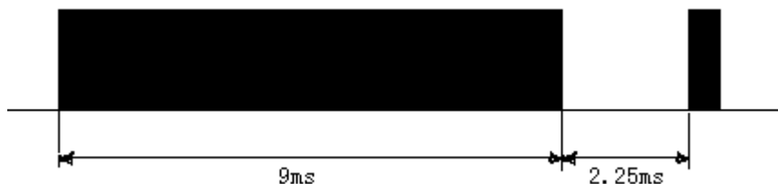
图 9 PT2222-14 重复码波形
