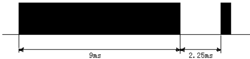
图 9 第二次传送波形（重复码波形）
