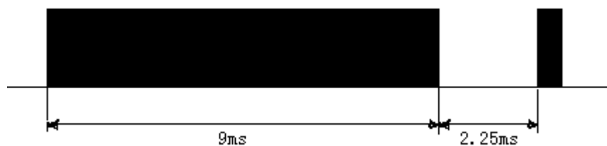
图 9 PT2222 的第二次传送波形 (重复码波形)
